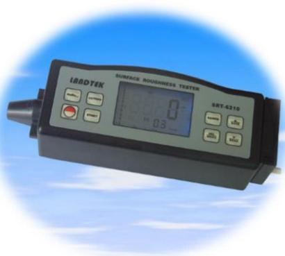
Appareil tout en un qui permet de mesurer la rugosité de surface (Ra, Rz) des matériaux. Une touche diamant est déplacée mécaniquement sur la zone pour en déterminer la rugosité qui est affichée sur l'écran LCD. La sonde de ce modèle sort latéralement pour permettre d'entrer dans des orifices de diamètre >6mm.
