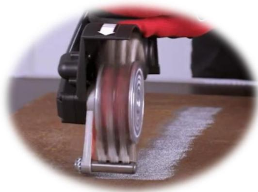
Action-NDT est distributeur officiel des solutions Monti sur le territoire Français. La Bristle Blaster est un outil breveté bien connu depuis des années permettant d'obtenir un niveau de propreté SA 2.5/3 et une rugosité Rz supérieure à 80µm sur de l'acier. C'est l'alternative économique et technique idéale au décapage à l'abrasif (sablage) lorsque celui-ci est difficile d'utilisation (quantité de déchets, espaces confinés, travaux sur corde, petite surface, nuisances sonores,..).
